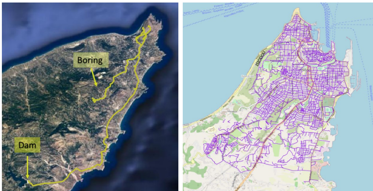
Σχήμα 3: Το σύστημα ύδρευσης του Δήμου Ρόδου: (α) Δίκτυο Μεταφοράς, (β) Δίκτυο Διανομής.
